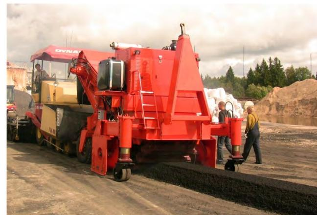
**БЦМ-261 и БЦМ-262** – комплекс машин для реализации технологии скоростной непрерывной укладки асфальта
