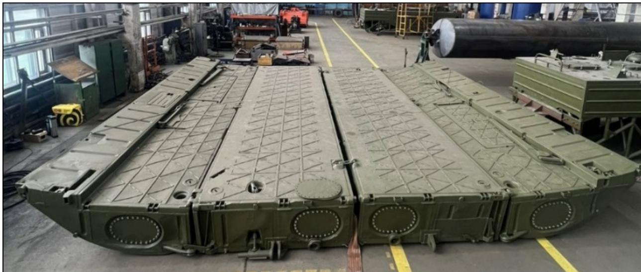
В состав речного звена входит два средних и два крайних понтона, понтонные механизмы, устройства и съемная оснастка.
