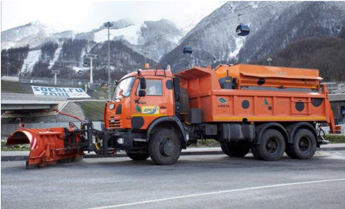
ЭД500АК на базе трехосного автосамосвала КАМАЗ-65115 является популярной машиной для всесезонного обслуживания скоростных автодорог и автомагистралей с твердым покрытием. Благодаря удачной компоновке на ЭД500АК возможна установка максимального спектра дополнительного навесного оборудования. Богатый выбор комплектаций позволяет подобрать оптимальную машину для выполнения ваших задач.
