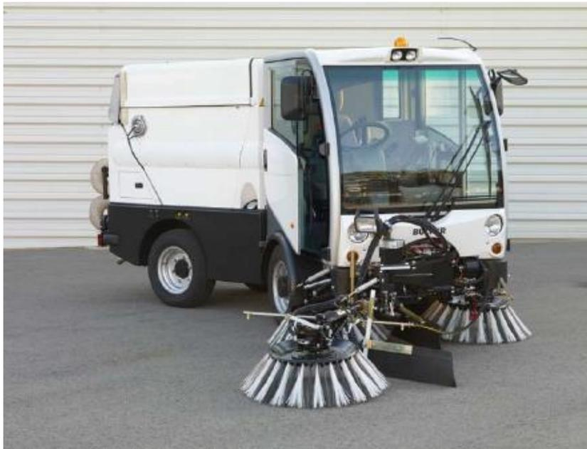
Компактная подметально-вакуумная машина Вакуумная уборочная коммунальная машина ВКМ 2020 специально сконструирована для использования в городских условиях, где требуется непревзойденная маневренность, низкий уровень шума, высокая производительность, большая автономность работы и легкость в эксплуатации.
