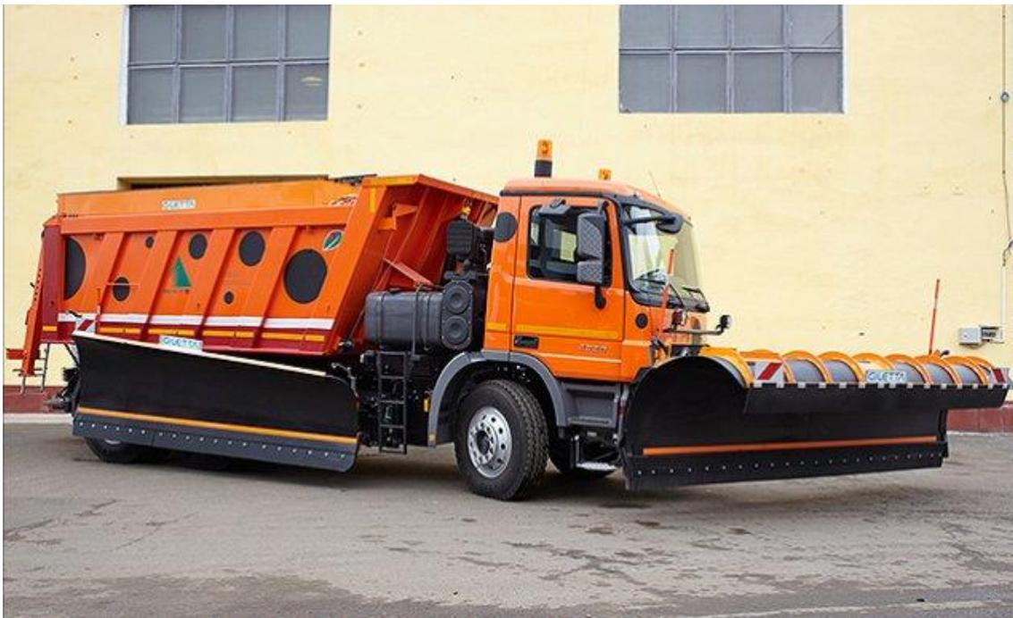
Автомобиль-самосвал Mercedes Benz Actros 3336К наилучшим образом подходит для построения на его базе многофункциональной комбинированной дорожной машины для патрульной и скоростной снегоочистки, распределения на проезжей части твердых и увлажненных противогололедных материалов в автоматическом режиме, распределения жидких реагентов.
