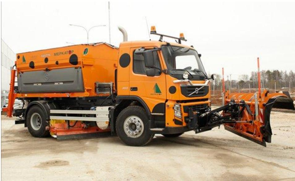
Комбинированная дорожная машина на базе шасси Volvo FL, предназначена для всесезонного содержания автодорог и улиц городов. Богатый выбор комплектаций позволяет подобрать оптимальную машину для выполнения ваших задач.
