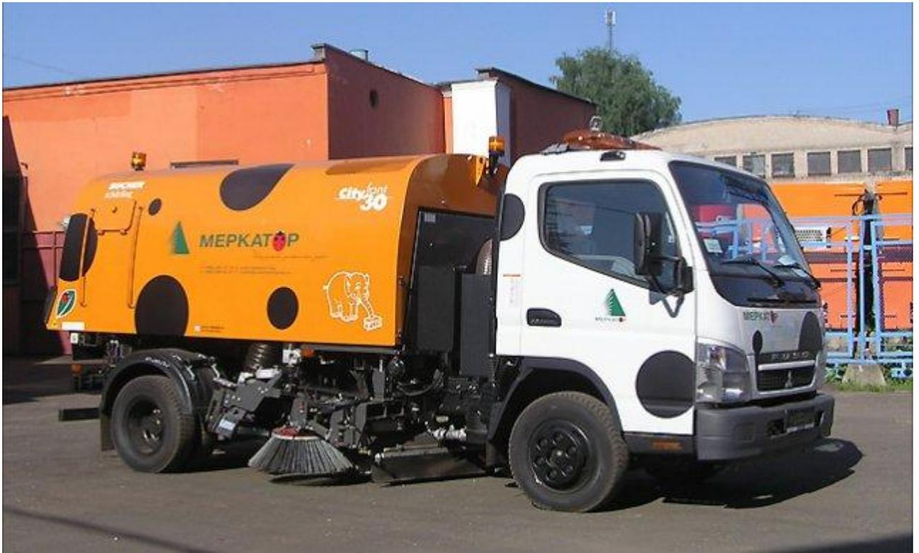
Машина подметально-вакуумная ЭД100Ф на базе Fuso предназначена для автоматизированной уборки мусора на городских улицах и межквартальных территориях в летний период.
