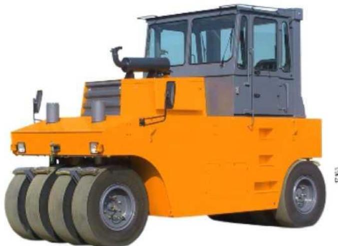
Поворот колес одной оси двумя группами (высокая устойчивость машины)
