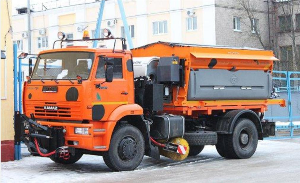
Многофункциональная дорожная машина ЭД300К на базе двухосного шасси КАМАЗ-53605 с газовым двигателем идеально подходит для круглогодичного выполнения работ по содержанию автомобильных дорог и городских улиц.
