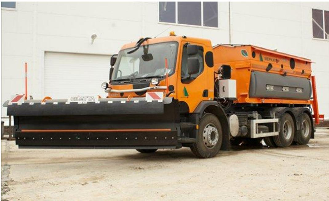
Машина дорожная комбинированная ЭД-700 на базе шасси VOLVO FM13, предназначена для всесезонного содержания скоростных федеральных и региональных автомобильных дорог с твердым покрытием.
