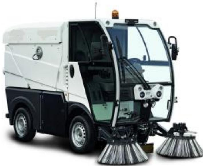
Компактная вакуумная подметально-уборочная машина Вакуумная уборочная коммунальная машина ВКМ 1000 предназначена для летнего (основная комплектация) и зимнего (опции) содержания дорог и территорий с твердым покрытием. Небольшие размеры машины, бункер объемом 1 м<sup>3</sup>, два поворотных моста, экономичный дизельный двигатель и высокопроизводительная вакуумная установка с системой пылеподавления - вот отличительные особенности этой машины.
