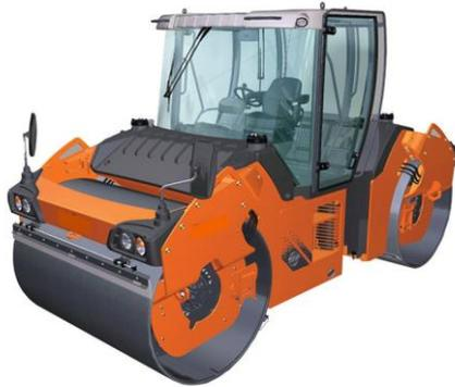
Двухвальный дорожный каток с двумя вибрационными бандажами с управлением поворотом задней оси
