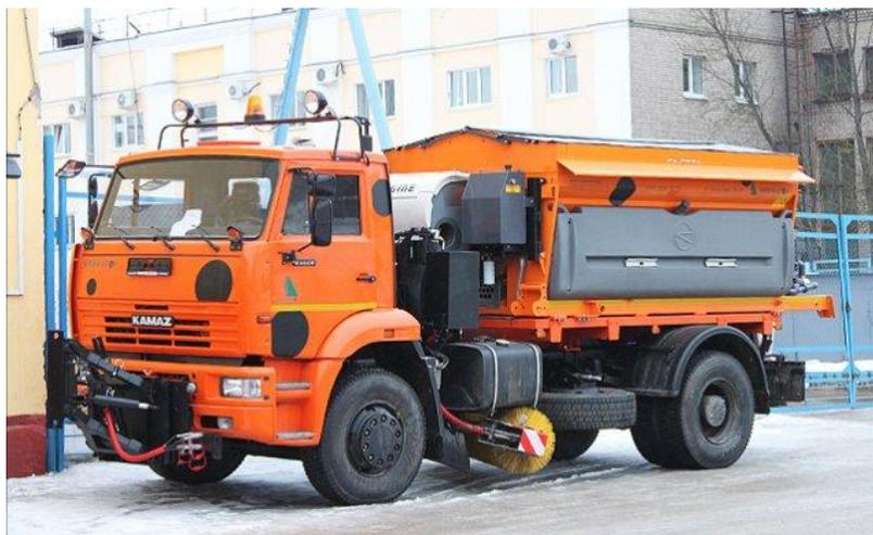
Многофункциональная дорожная машина ЭД-244КМ на базе двухосного шасси КАМАЗ-53605 идеально подходит для круглогодичного выполнения работ по содержанию автомобильных дорог и городских улиц.
