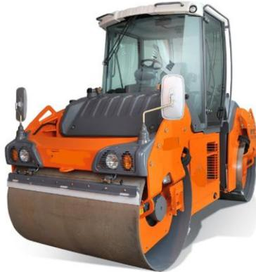
Двухвальцовые дорожные катки с двумя вибрационными бандажами с управлением поворотом задней оси
