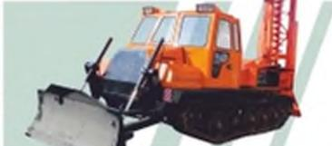
**Самоходная энергетическая машина СЭМ-4 (ямобур)** применяется для строительства линий электропередач и связи, для работ по обслуживанию и ремонту электросетей, натяжки проводов (включая высотные высоковольтные опоры) и др. высотных работ, перевозки опор ЛЭП и свай, завинчивания винтовых свай диаметром до 200мм, строительных и погрузо-разгрузочных работ.
