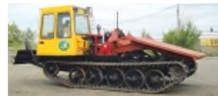
**Машина трелевочная чокерная МТЧ-4 с толкателем.**
