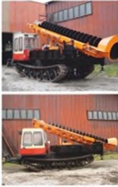
**Бурильная шнековая машина МБШ-539** предназначена для бурения скважин диаметром 800 мм в грунтах I-IV категорий для опор линий электропередачи. Использование шасси МТЧ-4 или ТЛ-5АЛМ позволяет эксплуатировать машину в труднопроходимых местах при неблагоприятных почвенноклиматических условиях.
