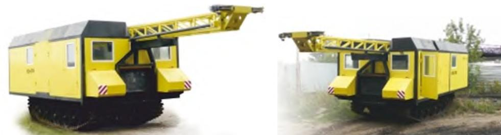
**Самоходная Буровая установка ТСБУ-200М** применяется для поисково-разведочного вращательного бурения вертикальных и наклонных скважин в труднодоступной горно-таежной местности в любое время года при температуре от +40 °С до -40 °С. Установка смонтирована на специальной раме-основании, укрепленной на базе трелевочной машины МТЧ-4 или трактора лесохозяйственного ТЛ-5АЛМ/ТЛ-5АЛ М-01.
