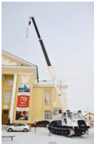
**Кран самоходный КС-5671 Б** - Грузоподъемность крана 25 тонн. По своему конструктивному исполнению и техническим характеристикам не имеет аналогов в России.
