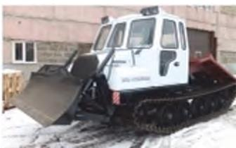
**Машина для бесчокерной трелевки леса Л1П-18АЛ М** предназначена для сбора поваленных деревьев (хлыстов) и трелевки их на лесопогрузочный пункт, а также для выравнивания комлей хлыстов и уплотнения штабеля, выравнивания трелевочных волоков и погрузочных площадок. Навесное оборудование, состоящее из стрелы, колонны, рукоятки, захвата, коника, толкателя, щита, гидросистемы и защитных кожухов, смонтировано на шасси машины трелевочной МТЧ-4.
