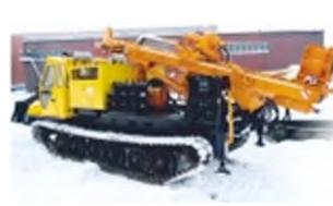
**Бурильная машина МРК-750Т** предназначена для бурения круглых скважин в грунте с I по IV категории включительно, для опор линий электропередач, мостов, переходов, столбов ограждения, а также свайных фундаментов зданий и сооружений. Бурильная машина может переоснащаться сменным бурильным инструментом, что позволяет увеличить глубину бурения до 9 метров.
