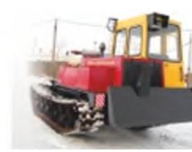
**Трактор лесохозяйственный ТЛ-5АЛМ** (6 опорных катков, трехместная кабина, двигатель ЯМЗ), **ТЛ-5АЛМ-01** (5 опорных катков, двух/трехместная кабина, двигатель ЯМЗ) предназначен для использования в качестве шасси для различных видов специального оборудования (бурильное, крановое, крано-манипуляторное, сварочное, контейнеры и др.).
