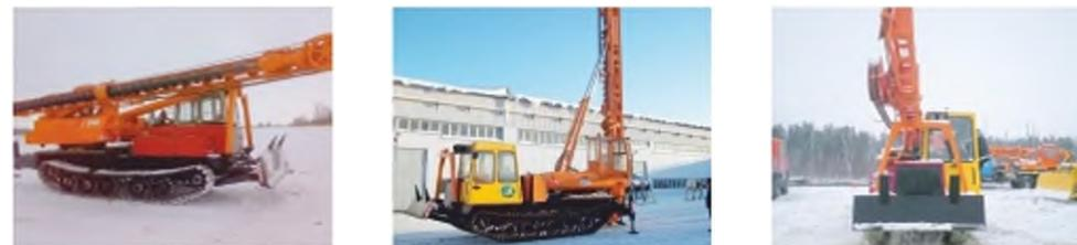
**Бурильно-крановая машина (ямобур) БМ-534** представляет собой буровой агрегат в комплекте с крановым оборудованием грузоподъемностью до 2 т, находит применение в условиях сложного ландшафта и труднодоступных местах.
