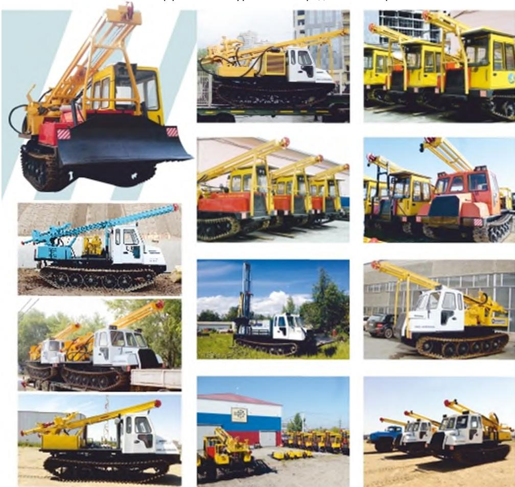
**Буровая установка ПБУ-2** - универсальная многоцелевая передвижная бурильная установка, предназначена для проведения различного вида геологических работ: сейсморазведочных, бурение гидрогеологических и геологоразведочных скважин инженерно-геологических изысканий, бурения скважин для строительства. Может эксплуатироваться в суровых климатических условиях при температурном режиме от -40 °С до +40 °С.
