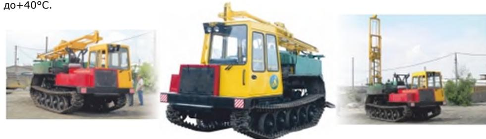
**Самоходная буровая установка УСБ-5ТМ** - предназначена для бурения с поверхности вертикальных и наклонных геологоразведочных скважин на твердые полезные ископаемые колонковым способом при температурах окружающего воздуха от -40 °С до +40 °С.
