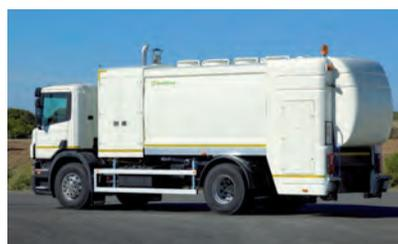
Установка для мойки мусорных баков горячей и холодной водой. Вращающиеся моечные головки и стационарная штанга с форсунками, расположенные в задней части машины и в хорошо защищенном отсеке высокого давления, очищают контейнеры емкостью до 1100 л.
