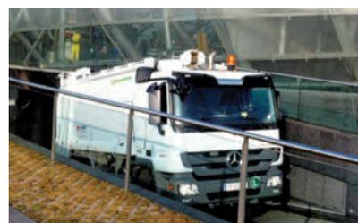
Данный мусоровоз с прессующей плитой отличается повышенной рентабельностью, эффективностью и тихой работой. Его дизайн элегантен и эргономичен. Модели присущи экологичность, безопасность и функциональность. На выбор представлены три типа конструкции загрузочного бункера. Кабина оснащена регулятором прессования для различных типов мусора. Предлагаются машины вместимостью от 10 до 27 м<sup>3</sup>.
