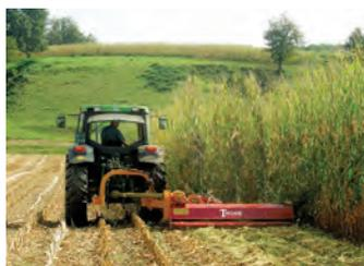
TornadoS -цеповые косилки заднего навешивания с откидывающейся режущей головкой и гидравлическим смещением.
