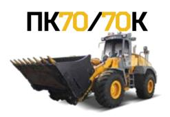
ФРОНТАЛЬНЫЙ КОЛЕСНЫЙ ПОГРУЗЧИК ГРУЗОПОДЪЕМНОСТЬЮ 7,0 Т.
