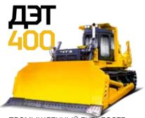
ПРОМЫШЛЕННЫЙ БУЛЬДОЗЕР ТЯГОВОГО КЛАССА 25 С ВЕНТИЛЬНО-ИНДУКТОРНЫМИ ЭЛЕКТРОМАЦІИНАМИ
