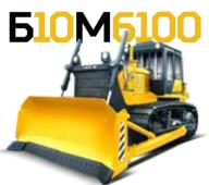
БУЛЬДОЗЕР С ДВИГАТЕЛЕМ ЯМЗ И МЕХАНИЧЕСКОЙ ТРАНСМИССИЕЙ ТЯГОВЫЙ КЛАСС 10
