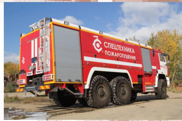
**Автомобиль повышенной проходимости предназначен для тушения пожаров на воздушных судах и в условиях аэропортовых комплексов. На корме смонтирована съемная установка покрытия взлетной полосы аэродрома пеной.**
